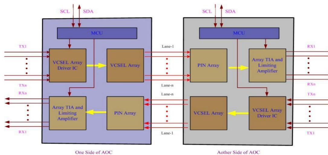
Figure1. Module Block Diagram
